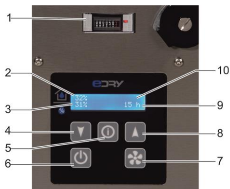
Fig. 3: Vista geral do painel de controlo
